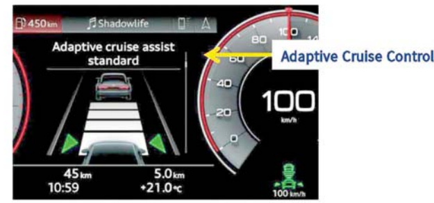
ပုံ ၃။ လိုက်လျောညီထွေအရှိန်ထိန်းချုပ်စနစ်ကို တွေ့မြင်ရစဉ်။
