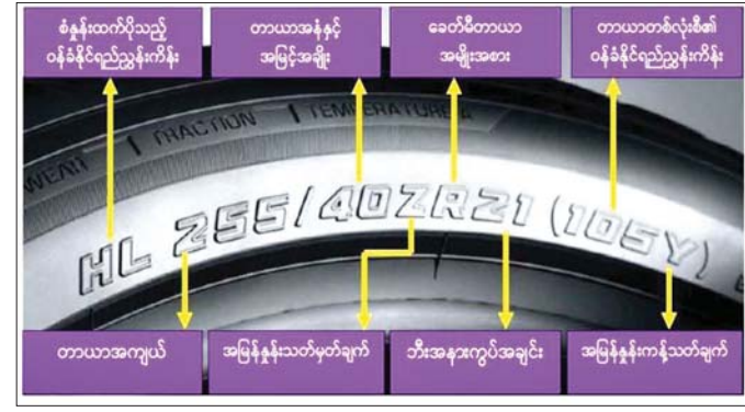
ပုံ ၆။ EV တာယာတစ်ခုရှိ အမှတ်အသားများကို တွေ့ရစဉ်။
