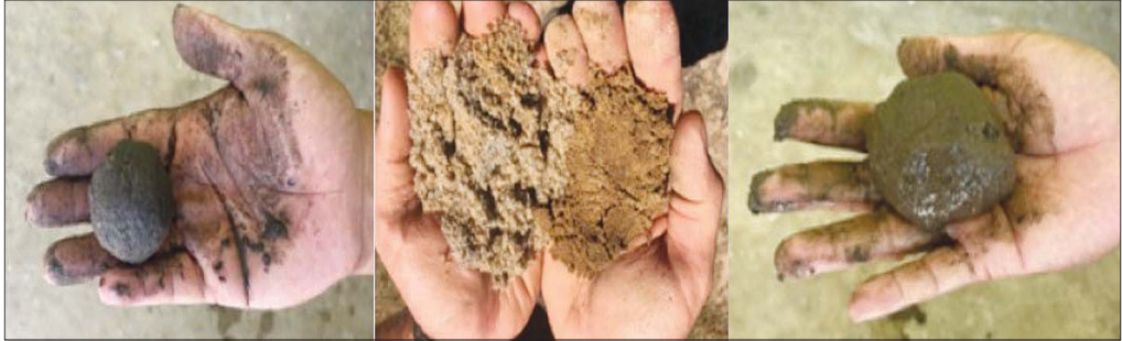
ကိုယ်တိုင်လက်တွေ့ လွယ်ကူစွာ စမ်းသပ်နိုင်သည့် မြေဆီလွှာအစိုဓာတ်စစ်ဆေးခြင်း နည်းလမ်းအသုံးပြုပုံ။
